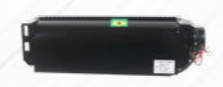
GNL-FB1042B-J-08 • FB-1042B-J - 风机 • Rotate Speed:1350(rpm) - 转速 • Air Volume:7(m 3 /min) - 风量 • Power:35(w) - 功率 • Outlet Size:420X43(mm) - 外尺寸 • Install size:446X90(m 3 /min) - 安装尺寸
