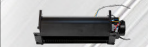
GNL-330B-04 • ZQF-330B - 风机 • Rotate Speed:1700(rpm) - 转速 • Air Volume:5.5(m 3 /min) - 风量 • Power:35(w) - 功率 • Outlet Size:330X43(mm) - 外尺寸 • Install size:380X90(mm) - 安装尺寸
