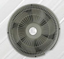
GNL-BRB-23 • BRB - 风机 • Rotate Speed:1300(rpm) - 转速 • Air Volume:6.0(m 3 /min) - 风量 • Power:45(w) - 功率 • Install size:300(mm) - 安装尺寸
