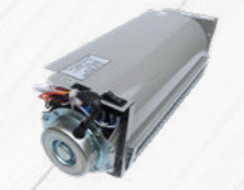
GNL-FB1035B-10 • FB-1035B - 风机 • Rotate Speed:1250(rpm) - 转速 • Air Volume:6.5(m 3 /min) - 风量 • Power:25(w) - 功率 • Outlet Size:360X43(mm) - 外尺寸 • Install size:380X90(mm) - 安装尺寸
